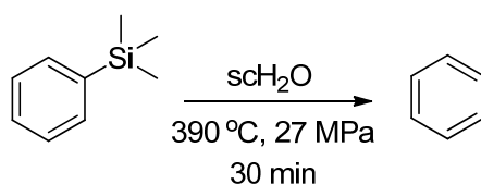
Scheme 1-14 超临界水下脱硅反应
